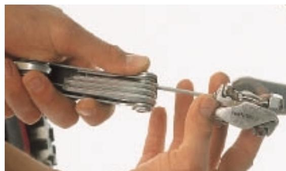
**5** Ziehen Sie die Cleatschrauben fest an. Tasten Sie sich nun langsam an die für Sie richtige **PEDAL-AUSLÖSEHÄRTE** heran. Diese vergrößert sich, wenn Sie die Einstellschraube im Uhrzeigersinn drehen. Gehen Sie dabei in kleinen Schritten vor. Stellen Sie die Auslösehärtigkeit links wie rechts und auf beiden Seiten des Pedals gleich ein. So vermeiden Sie unliebsame Überraschungen.
